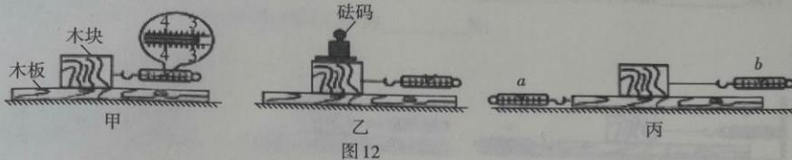
(2)比较图 12 甲、乙,可以探究滑动摩擦力大小与\_\_\_\_\_的关系。若换用图 12 丙的方式来测量,在拉动长木板的过程中发现,当弹簧测力计 *b* 的示数稳定后为 2.7N,弹簧测力计 *a* 的示数为 4.5N,则木块和木板之间的摩擦力为\_\_\_\_\_N。
