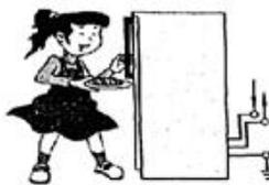
C.将冰箱的金属外壳接地
