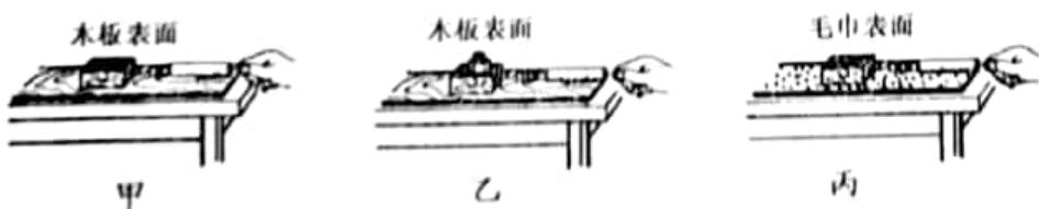
(1)实验过程中,弹簧测力计必须沿水平方向拉着物块做\_\_\_\_\_运动,此时滑动摩擦力的大小等于弹簧测力计的示数,所依据的原理是\_\_\_\_\_;
